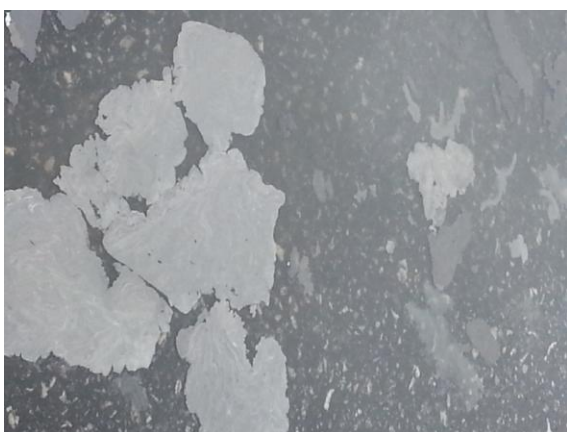
Hình 4. Vết đen xuất hiện khi khoan mẫu QL1 đoạn Vinh - Hà Tĩnh (ngày 13 tháng 6 năm 2014)
