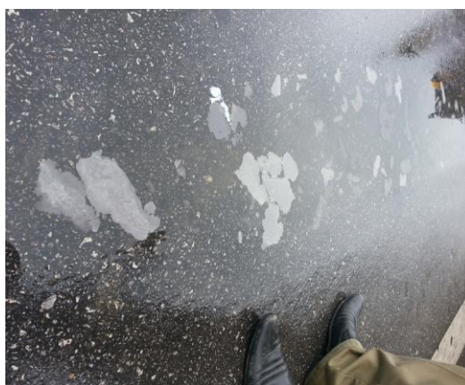
Hình 4. Vết đen xuất hiện khi khoan mẫu QL1 đoạn Vinh - Hà Tĩnh (ngày 13 tháng 6 năm 2014)
